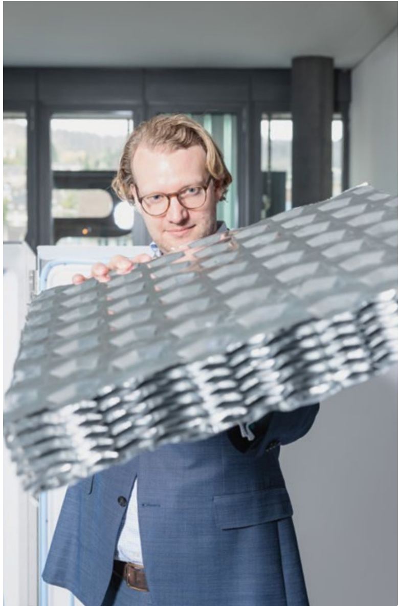
CEO Richard Ettl zeigt das hochwirksame Isolationsmaterial der Kühlcontainer. Es besteht aus mehreren wabenartigen Schichten, gefertigt aus PET-Abfällen.
