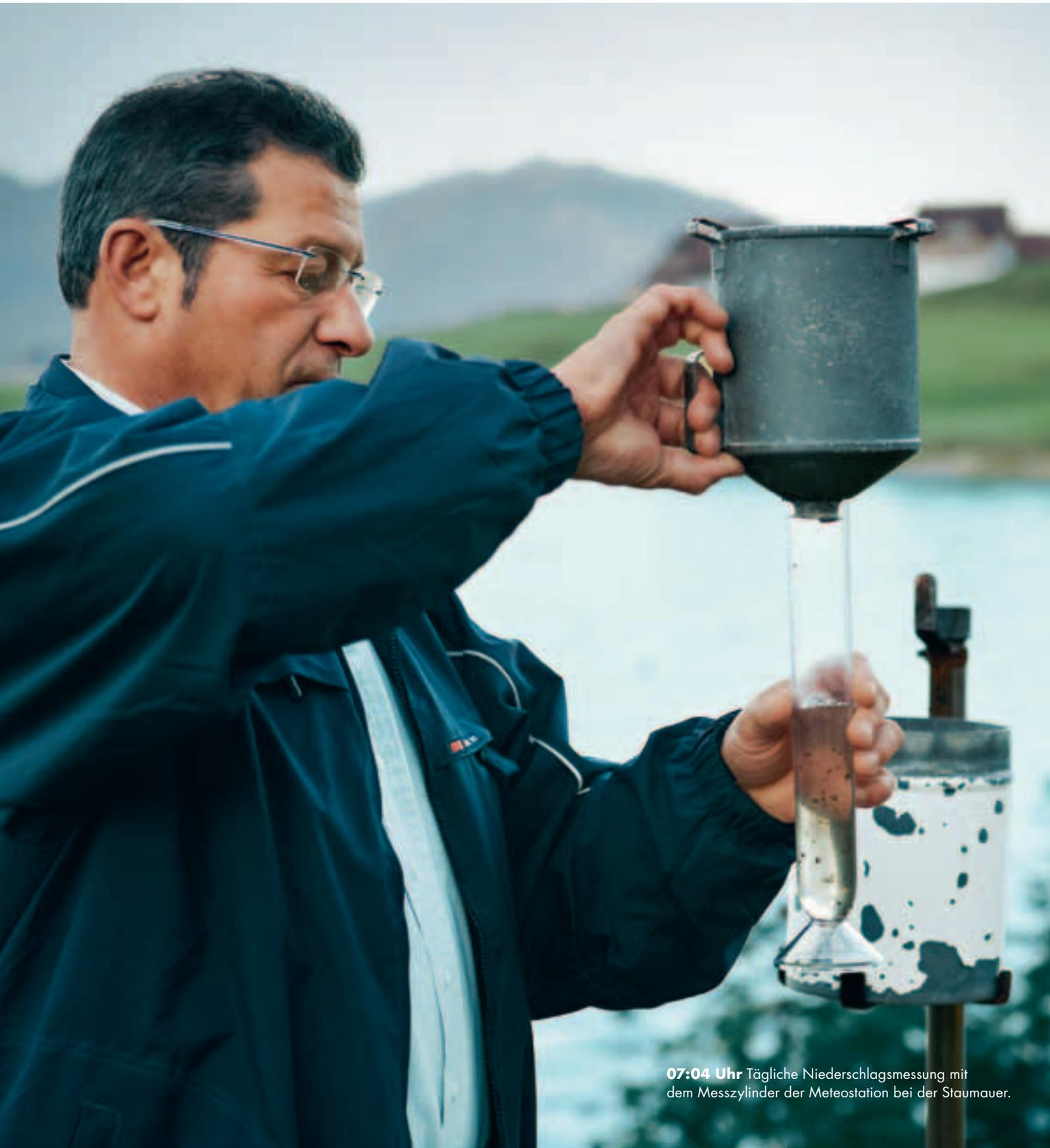
**07:04 Uhr** Tägliche Niederschlagsmessung mit dem Messzylinder der Meteostation bei der Staumauer.
